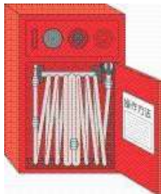
屋内消火栓設備
