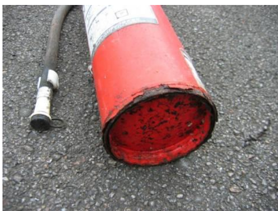
消火器底部の腐食
