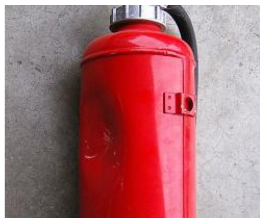
消火器の変形
